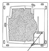
Taster zum Rücksetzen der Filterüberwachung
